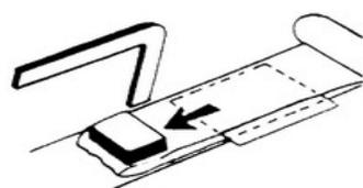
2) mise en place du produit dans le cadre soudure
