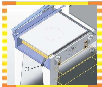
(1) Afin de faciliter le réglage en hauteur du plateau de réception produit En option il peut être proposé ce système de montée et descente du plateau actionné manuellement à l'aide de la poignée 1.
