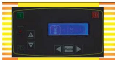
Les réglages des caractéristiques des temps de soudure et de refroidissement sont accessibles par clavier souple
