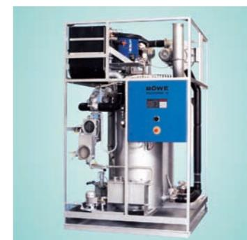
Die Mehrchargen-Aktivkohle-anlage POLYSORBA SI
