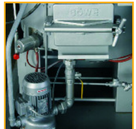
Die automatische emissionsfreie Destillationsentsorgung erfordert im Normalbetrieb keine manuellen Arbeiten
