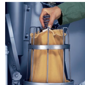
Nur einmal täglich zu reinigen: der Hauptflusenfilter
