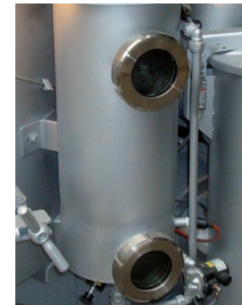
Wartungsfrei: der selbstreinigende Wasserabscheider mit integriertem Nachwasserabscheider
