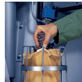
Nur einmal täglich zu reinigen: der Hauptflusenfilter
